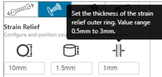
그림 39: Strain Relief 매개변수
